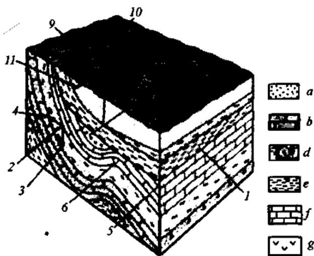
**20-rasm. Qatlamlarning yotish elementlari.** a-qumlar, b-qumtoshlar;
