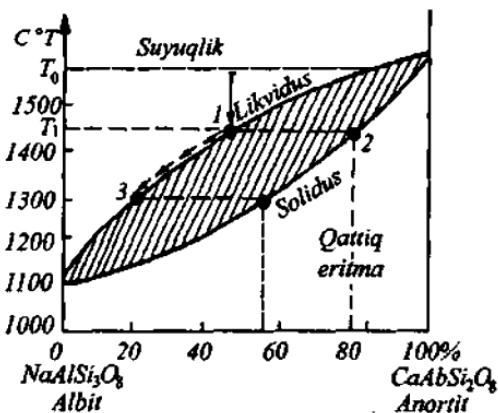
102-rasm. Plagioklaz qatoridagi qattiq eritmalar uchun suyuqlanish diagrammasi (N. Bouen bo'yicha). Shirixlar bilan belgilangan maydonda kristallar va suyuqlikning birga mavjud bo'lishi ko'satilgan. Suyuqlikdan ajralib chiquvchi kristallar tarkibi abssissa o'qida aniqlanadi. 1-3-suyuqlikning kristallanish bosqichlari rivojlanishi.
