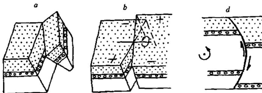
74-rasm. Ikkinci xildagi uzilma strukturalar: a-teskari; b-sharnirli; d-silindrik uzilmalar (A.Ye.Mixaylov bo'yicha).
