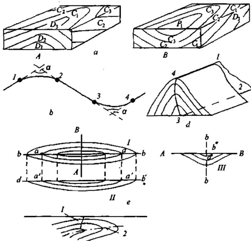
50-rasm. **Burma va uning elementlari.** (A) antiklinal va sinklinal (B) burmalar; b-burma qanotlari va gulf'i; d-burma o'q tekisligi; I-planda, II-bo'ylama kesmada va III-ko'ndalang kesmada ko'rinishi; e - burma o'rkhachi, 1-o'rkhach tekisligi, 2-o'q tekisligi (A.Ye.Mixaylov bo'yicha).
