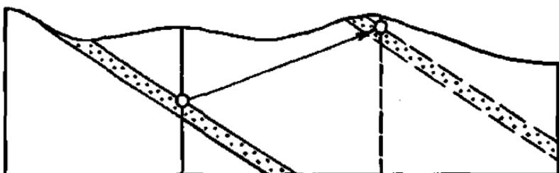
95-rasm. Qo'shma vertikal kesma yordamida aralash strukturalarning haqiqiy srlish amplitudasini aniqlash.
