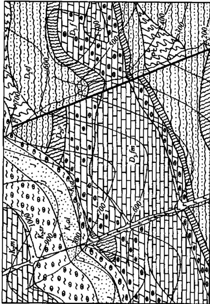
64-rasm. Yer yorqlari bilan surakkablashgan sinklinal va antiklinal burnalarining geologik xaritada tasvirlanishi.
