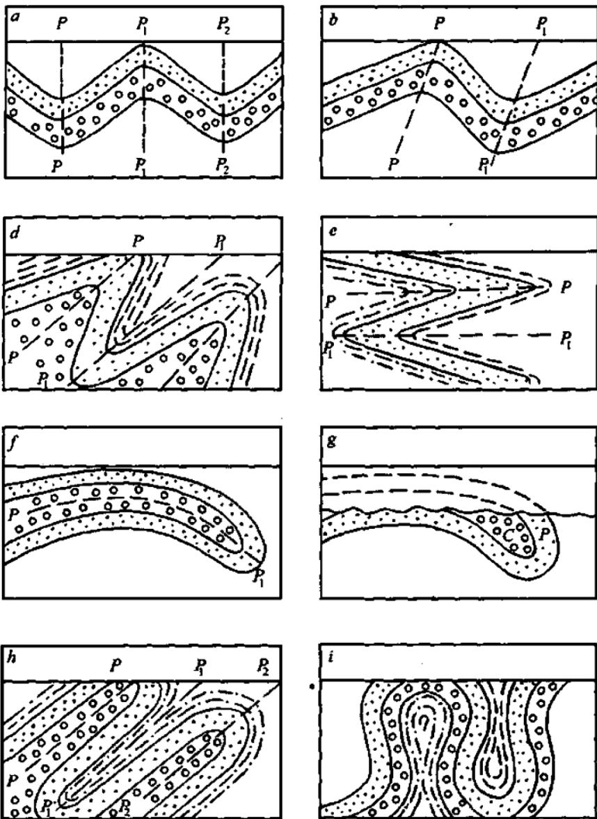
**52-rasm. Burmali struktura turлari:** a-simmetrik, b-asimmetrik, d-to'ntarilgan qиya, e-yotuvchi, f va g - sho 'ng'uvchi, h-izoklinal, i-yelpig'ichsimon burma; PP, P<sub>1</sub>P<sub>1</sub> va P<sub>2</sub>P<sub>2</sub>-burmalarning o'q chiziqlari (A.Ye.Mixaylov bo'yicha).
