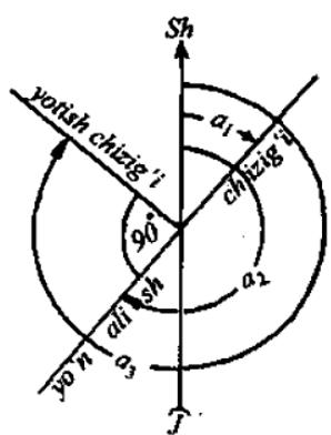
**33-rasm. Planda qatlamning yotish elementlari orasidagi munosabat.**  *$\alpha_1$  va  $\alpha_2$  - yo'nalish chizig'ining azimutlari,  $\alpha_3$  - yotish chizig'ining azimuti.*
