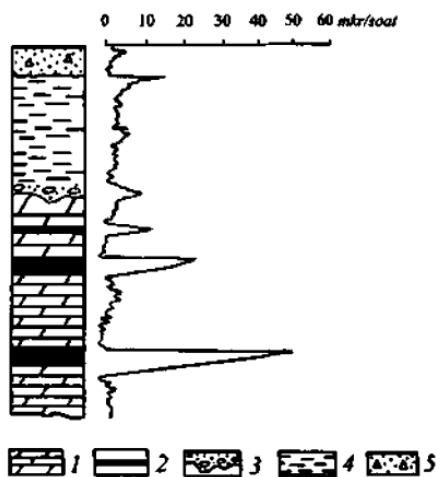
15-rasm. Burg'i qudug'ining gamma karotaj diagrammasi.
