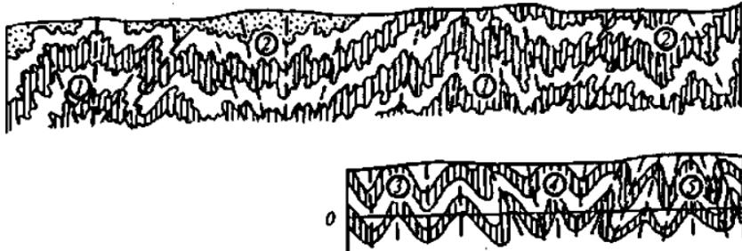
135-rasm. Burmalli strukturalar kombinasiyasi: 1-antiklinoriy; 2-sinklinoriy. Vergent shakllari: 3-konvergentli; 4-divergentli; 5-antivergentli (V.N.Pavlinov bo'yicha).
