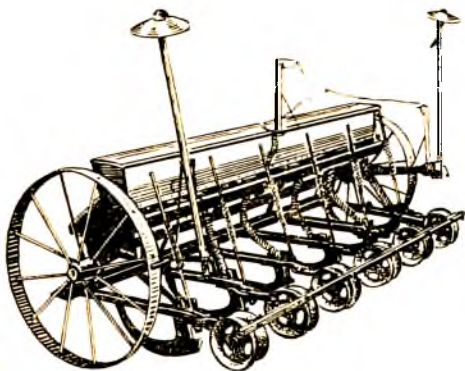
26- расм. СОН - 2,8А маркали сабзавот сеялкаси.
