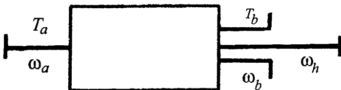
3.37-shakl. Planetar uzatmaning strukturaviy sxemasi.
