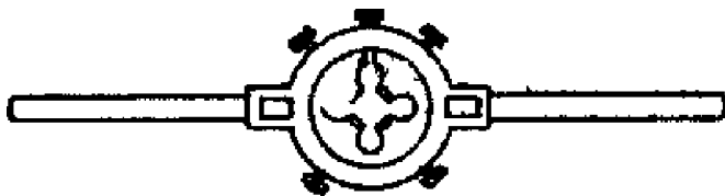
1.23-rasm. Tashqi rezba kesish uchun vorotok va plashka.
