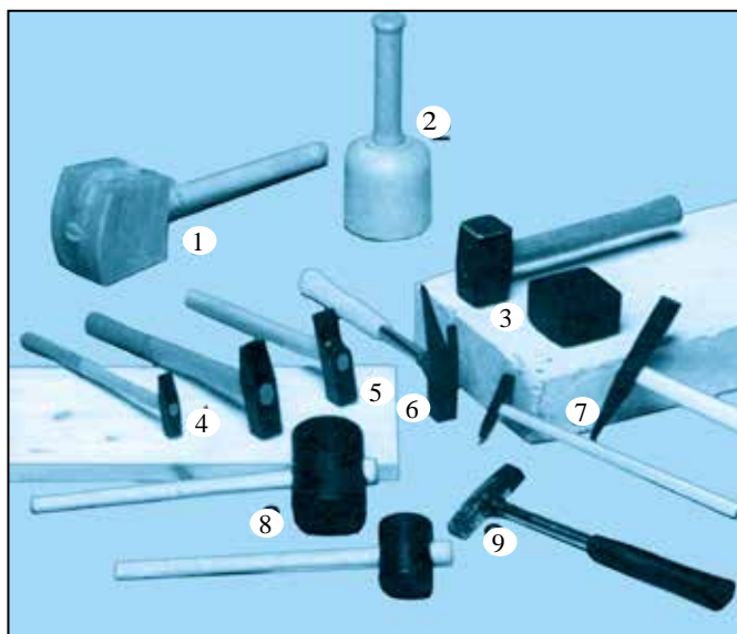
13-rasm. Chilangarlik bolgʻalari va yogʻoch toʻqmoq: 1, 2 – yogʻoch bolgʻalar; 3, 4, 5, 6, 7 – poʻlat bolgʻalar; 8, 9 – plastik bolgʻalar.
