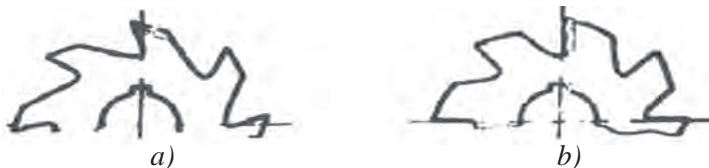
34-rasm. Frezarlar shakli: a – oʻtkir charxlangan tishli; b – pardozlovchi tish.
