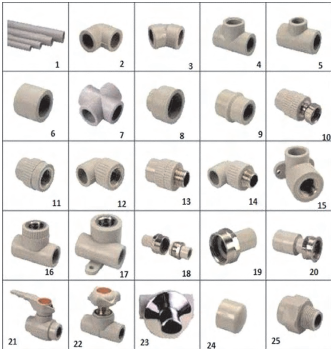
21-rasm. Plastmassa trubasiga oʻrnatiluvchi maxsus moslamalar: 1 – truba; 2 – 90° li ulagich; 3 – 120° li ulagich; 4, 5 – tarmoqlagich; 6 – toʻgʻri ulagich; 7 – tekis tarmoqlagich; 8, 9 – oʻlchamni oʻzgartiruvchi ulagich; 10, 11 – tashqi temir-plastmassa ulagich; 12 – tashqi 90° li temir-plastmassa ulagich; 13 – ichki toʻgʻri temir-plastmassa ulagich; 14, 15 – ichki 90° li temir-plastmassa ulagich; 16, 17 – tarmoqlagichdan ichki 90° li temir-plastmassa ulagich; 18, 19, 20 – tashqi temir ulagich, 21, 22 – plastmassa kalit; 23 – temir ulagich; 24 – qopqoq; 25 – burama qopqoq.
