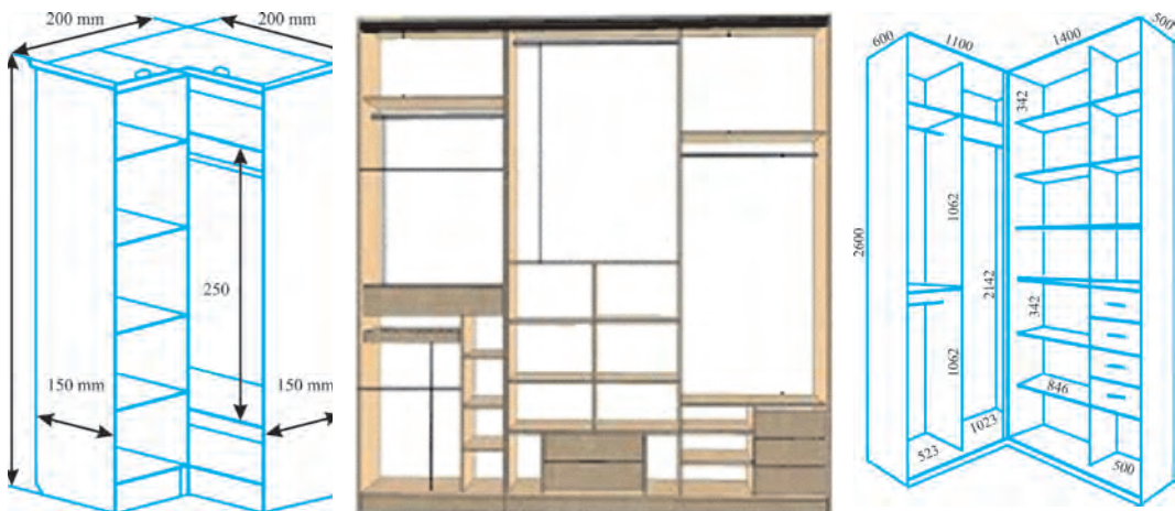
9-rasm. Turli xildagi shkafni tayyorlashda o'lcham olish va uni loyihalash ishlarini bajarish ish usullari.
