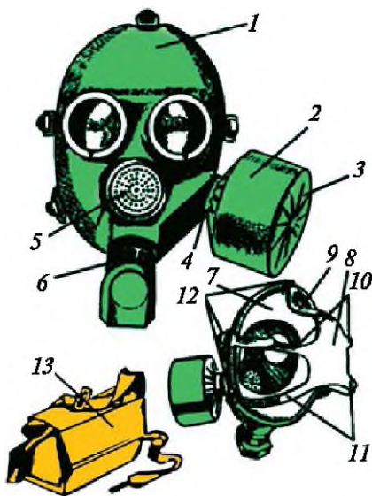
13-súwret. GP-5 gaz nıqabı: 1—nıqap; 2—hawa tazalawshı qutı; 3—trikotajdan islengen qap; 4—dem alıw trubkasınıń awzı; 5—sóylesiw uskenesi; 6—dem shıǵarıw trubkası, 7—obtyurator; 8—tóbelik; 9—mańlay buwǵıshı; 10—sheke buwǵıshı; 11—iyek astı buwǵıshı; 12—uzaytıp qısqartılatuǵın buwǵıshı; 13—qabı.
