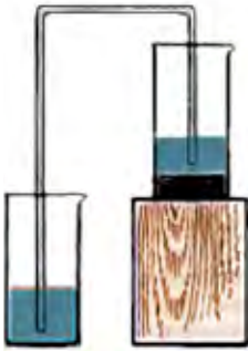
Расми 9. Таҳшин кардани оби лойка дар стакан ва аз он чудо карда гирифтани оби софи тоза
