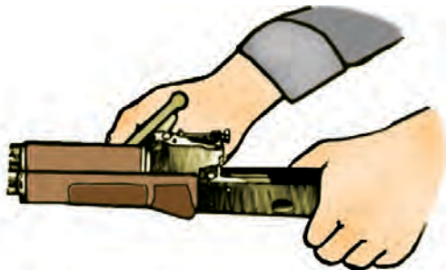
Расми 112. Чудо кардани трубкаи газ аз қундоқи мил.
