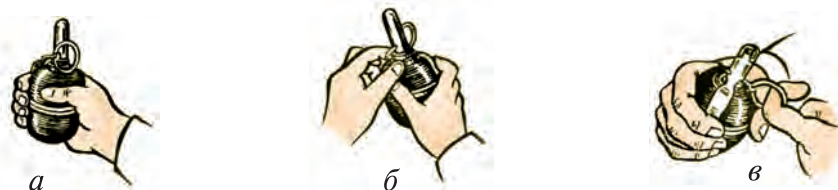
Расми 115. Пеш аз ҳаводиҳӣ ба ҳаракат овардани граната: a —копуси гарантаро бо ричаги идоракунанда доштан; б —аз охири чеки муҳофиз дошта истодан; в —канда гирифтани чеки муҳофиз.
