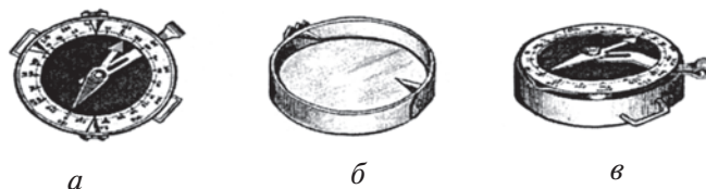
Расми 82. Компаси андрианов: а —намуди умумӣ; б —намуди сарпӯши компас бо мушқа; в —лимба (доираи дараҷабанди асбобҳои ченаки кунҷ).
