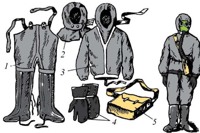
Расми 15. Костюми сабуки химоявӣ Л-1: 1 — пойпӯшо ва шим; 2 — либоси зери шлем; 3 — куртаи капюшондор; 4 — дастпӯшакҳои дуангушта; 5 — халтаи костюм. Дар рост — костюми химоя дар ҳолати «Ҷанговарӣ».
