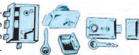
Расми 84. Қулфҳои пӯшида: а – кутишакл; б – муҳофиздори ду бор чархзанандаи кутишакл; в – кутишакли дорои сурма ва муҳофиз.
