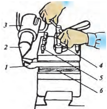
Расми 54. Теги харротиро ба дастаки теғ насб кардан: 1 – теғ; 2 – маркази баъдина; 3 – пиноли бабкаи баъдина; 4 – калид; 5 – винтҳои саҳткунии теғ; 6 – тиргакҳои теғ.
