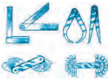
Расми 42. Асбобҳои ченкунии бешкала: а – гуния; б – малка; в – кронпаргор; г – нутромер, д – шаблонҳои радиус; е – шаблонҳои резба.
