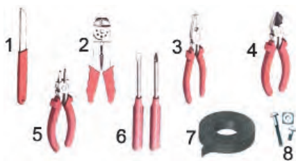
Расми 76. Асбобҳои кори электромонтаж: 1 – корди монтаж; 2 – дастгоҳи кушодани изолятсия; 3 – анбӯр; 4 – анбӯри тезчағ; 5 – анбӯри чағаш гирд; 6 – отвёркаҳо; 7 – тасмаи изолятсия; 8 – ашӯҳои саҳткунӣ
