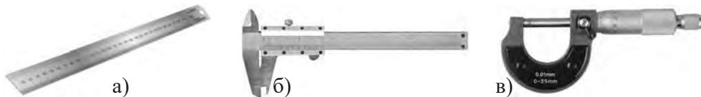
Расми 41. Асбобҳои ченкунии шкаладор: а – ҷадвал; б – штангенпаргор; в – микрометр.
