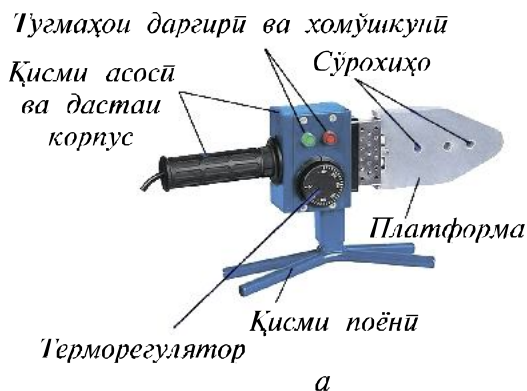
Расми 8. Асбоби пайвандкунӣ барои қубурҳои шластикӣ: а — соҳти асбоби пайвандкунӣ; б — қуттии маҷмӯъ.
