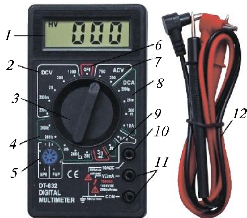
Расми 22. Сошти мултиметри тамгаи DT-832: 1 — дисплей; 2 — ченки қувваи тағйирнопазир; 3 — переключател; 4 — ченкунии муқовимат; 5 — хоначаи санҷидани транзисторон; 6 — хом-шкунӣ; 7 — ченкунии қувваи тағйирпазир; 8 — ченкунии ток; 9 — ченкунии қувваи тағйирнопазир; 10 — ченкунии токи 10 А; 11 — хонача барои аниққунандаҳо; 12 — симҳои (шупҳои) ченак.
