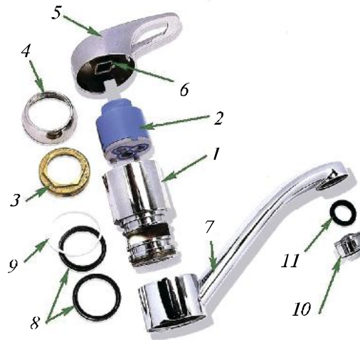
Расми 16. Соҳти асбоби смесители якфишанга (якричагдор): 1—корпуси металлӣ; 2—картриҷ; 3—гайкаи картиҷро маҳкамдоранда; 4—сарпӯши декоративӣ; 5—дастаки смесител; 6—дастираки дорои шакли мураббаъ, ки зери дастаки смесител ҷойгир аст; 7—бинии даврзананда; 8, 11—ҳалқаҳои резинӣ; 9—ҳалқаи фторопластикӣ; 10—аэратор (тӯри ҷимоя).
