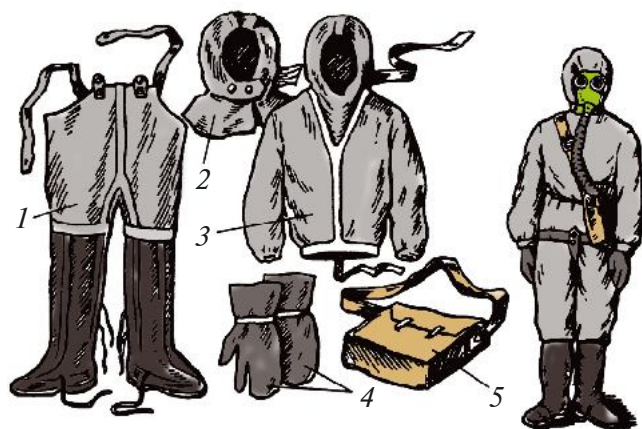
15-nji surat. L-1 ýeňil gorag kostýumy: 1 — joraplar we jalbar; 2 — şlemasty geými; 3 — kapýuşonly köýnek; 4 — iki barmakly ellikler; 5 — kostým saklanýan halta. Sagda «Söweşjeň» halatyndaky gorag kostýumy.
