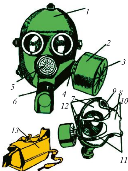
13-nji surat. GP-5 gaznykaby: 1 — nykap; 2 — howa arassalaýjy guty; 3 — triko-taşdan edilen daşlyk; 4 — dem alyş naýynyň agzy; 5 — gepeşik gurluşy; 6 — dem çykaryjy naýy; 7 — obturator; 8 — depelik; 9 — maňlaý daňysy; 10 — çekge daňysy; 11 — eňekasty daňy; 12 — uzaldyp gysgaldyjy daňy; 13 — jilt.
