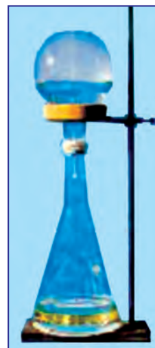
50-nji surat. HCl gazynyò suwda eräp, duz kislotasy erginini emele getirmegi.
