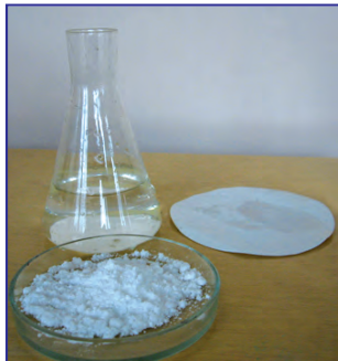
Reaksiýa wagtynda ýylylyk ýuwdulyp, kolbanyň aşagyna kagyz ýapyşyp galýar.
