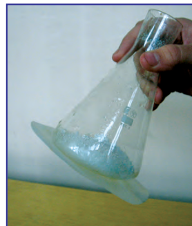
Reaksiýa wagtynda ýylylyk ýuwdulyp, kolbanyň aşagyna kagyz ýapyşyp galýar.
