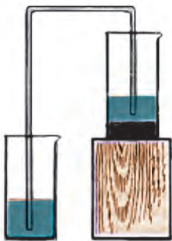
9-njy surat. Bulanyk suwy stakanda durlamak we ondan arassa dury suwy almak.
