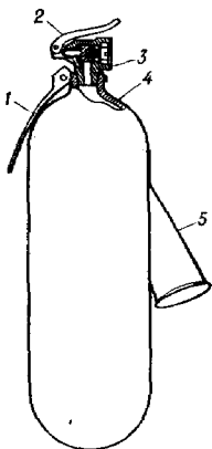
ОУ-5 маркали карбонат ангидридли ўт ўчирилма: 1 — тутқич; 2 — рычаг; 3 — беркитиш-нишга тушириш қурilmаси; 4 — баллон; 5 — пасадка
