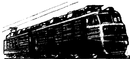
Ўзарувчан токда ишлайдиган саккиз ўқли ЧС4 маркали йўловчилар электрвози.
