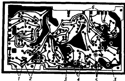
Босма плата: 1 — контакт майдончалар; 2 — босма электр токи ўтказгичлари; 3 — фольгаланган сирт уасткаси; 4 — электр изоляцияли оралик; 5 — металлланган тешиклар; 6 — тешик электр занжири билан уланган контакт майдонлар
