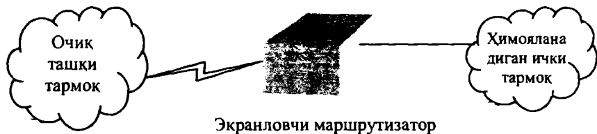
6.10-расм. Тармоқлараро экран – экранловчи маршрутизатор.
