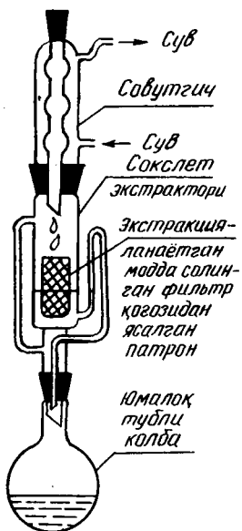
7- расм. Сокалет экстрактору каттик моддани эритувчи билан ёрдамида моддаларни ажратиш асбоби
