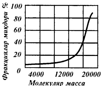
20-расм. Полиамиднинг молекуляр массаси бўйича тақсимланиш графиги.
