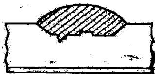
III.18-rasm. Kristall tuzilma buzilgan joyda elektrod materialdan yarimo'tkazgichning mahalliy suyulishi
