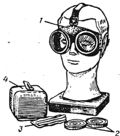
35 - rasm. OPF markali ko'zni himoyalovchi individual vosita. 1 - OPF himoyalovchi ko'zoynak; 2 - terlamaydigan plenka; 3 - salfetka; 4 - g'ilof.
