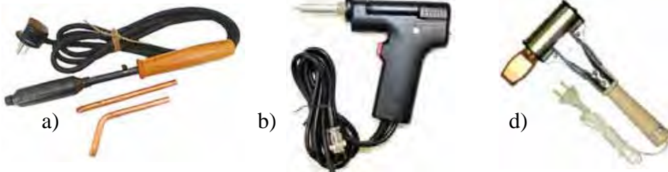
77-nji surat. Paýalnikler: a) ýönekeý; b) sapança şekilli; d) çekiç şekilli.
