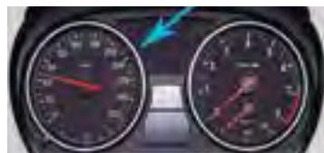
27-nji surat. Awtomobiliň spidometri
