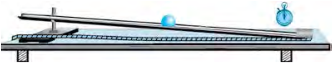
41-nji surat. Deňtizlenýän hereket tizlenmesini kesgitlemek üçin gurluş
